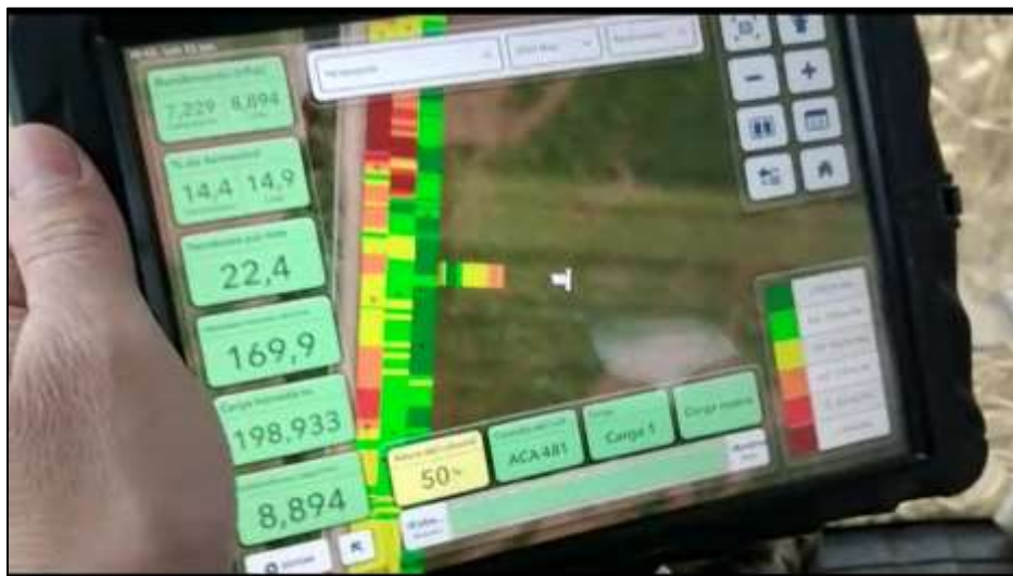
Imagen 1: Evaluación en tiempo real de ensayos en la cabina de la cosechadora, conectados a través de una app a los datos del monitor de rendimiento. Productor-Asesor-Contratista. Pampayasta, Cosecha Maíz 2019/20.
